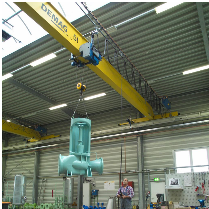
Figura 2 – Ponte Rolante realizando transporte
