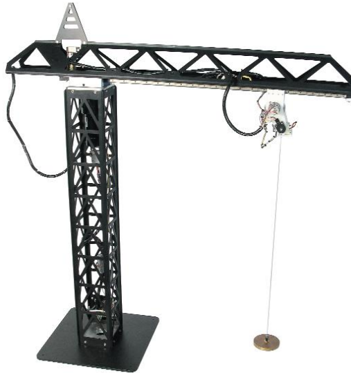
Figura 6 - Modelo de guindaste Quanser 3DOF Crane
